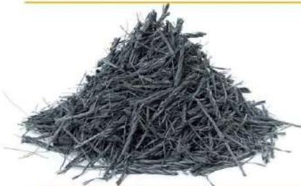
محصولی در رشته‌های میکرو و تینیده برپایه کوپلیمر پلی‌پروپیلن که در تقویت مقاومت خمشی و کششی بتن تاثیرگذار و از ترکخوردگی‌های بتن در حد قابل ملاحظه‌ای جلوگیری می‌کند.
