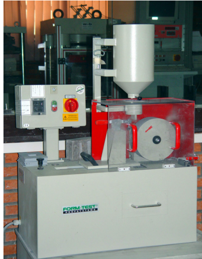
شکل ۱- دستگاه تعیین مقاومت سایشی طبق استاندارد (EN 1338 Appendix A)
