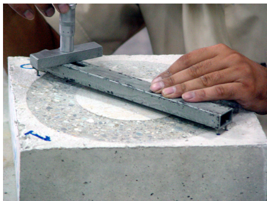
شکل ۴- نحوه قرائت عمق سایش بعد از انجام آزمون مطابق ASTM C779
