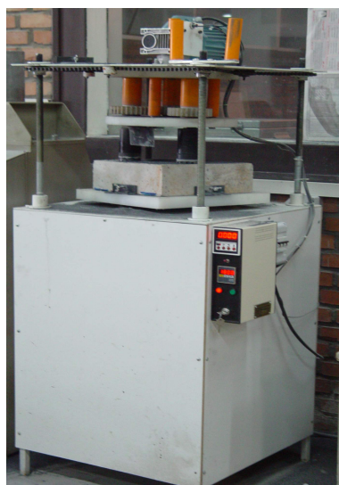
شکل ۳- دستگاه آزمایش ASTM C779 (دیسک چرخان)
